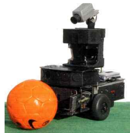
Fußball-Roboter des CS Freiburg: Nur das Gehäuse erinnert noch an einen Pioneer-Roboter.
