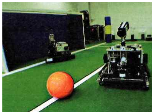
Torszene aus Robotersicht: Deutlich sichtbar der detektierte rote Ball, das blaue Tor und der Eckpfosten. Die kleineren blauen Flächen sind Störungen, die durch Kalibrierung und Filterung vermindert werden müssen.
